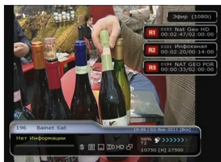
Работа PVR, одновременная запись трех программ и просмотр четвертой
