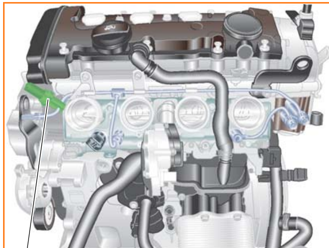
Датчик низкого давления G410
