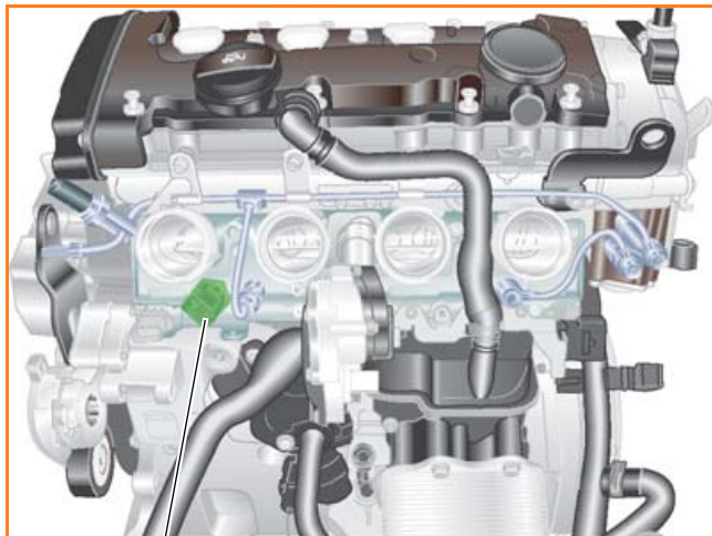
Датчик высокого давления топлива G247
